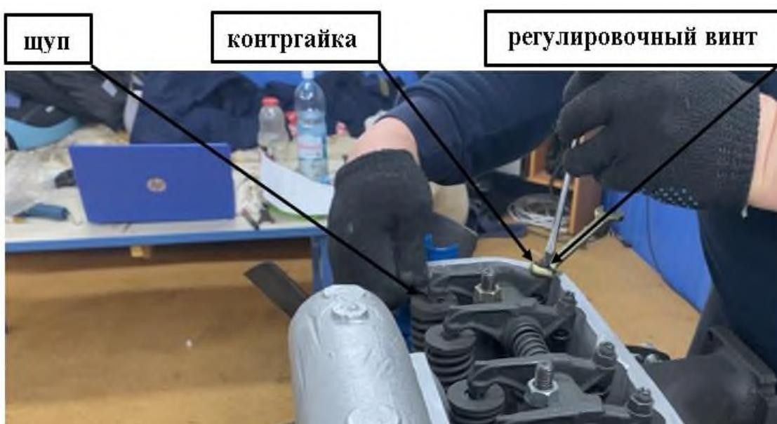
Рисунок 7 – Регулировка зазоров
