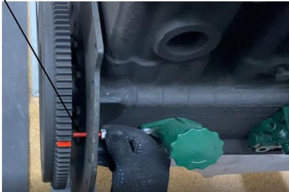
Рисунок 5 – Положение фиксатора
