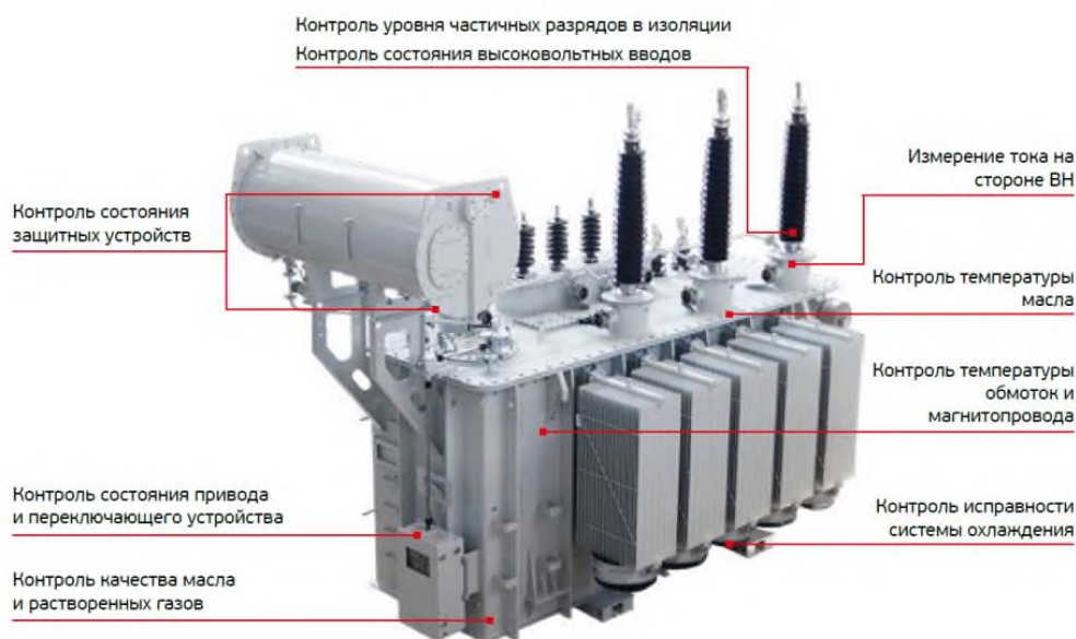
Рисунок 2 – Дополнительные функции управления, мониторинга и диагностики трансформаторов, применяемые в производстве силовых трансформаторов «Группы СВЭЛ»
