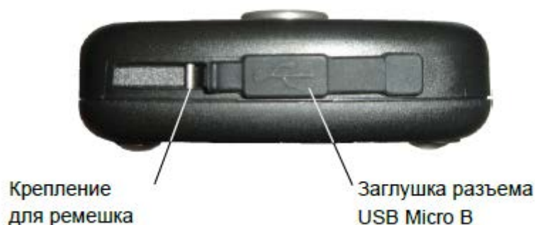
Рисунок 40 – Нижняя торцевая стенка электронного блока
